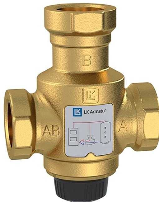
LK 823 ThermoVar® R ist ein 3-Wege thermisches Ventil für Heizanlagen mit Festbrennstoffkessel und Pufferspeicher. Das Ventil dient zur Rücklaufenhebung und sorgt dafür, dass eine optimale Temperaturschichtung im Pufferspeicher vorhanden ist. Dies erhöht die Effizienz der Heizanlage, verhindert Kondensation und Teerablagerungen, was die Lebensdauer des Heizkessels verlängert.
