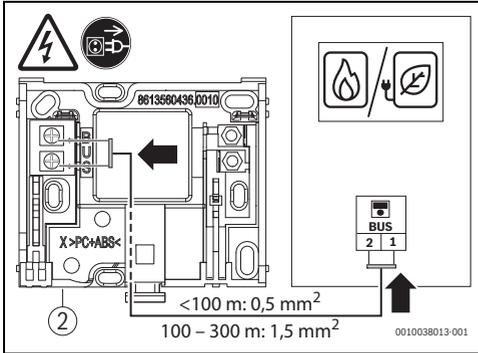
Bild 6 Anschluss der Bedieneinheit an einem Wärmeerzeuger
