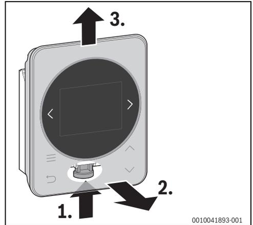
Bild 8 Bedieneinheit abnehmen
