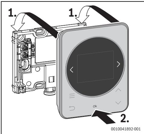
Bild 7 Bedieneinheit einhängen
